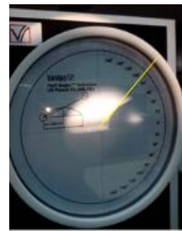
Figura 1. Toma de lectura del ángulo de contacto entre la gota muestra y el biopolímero.
